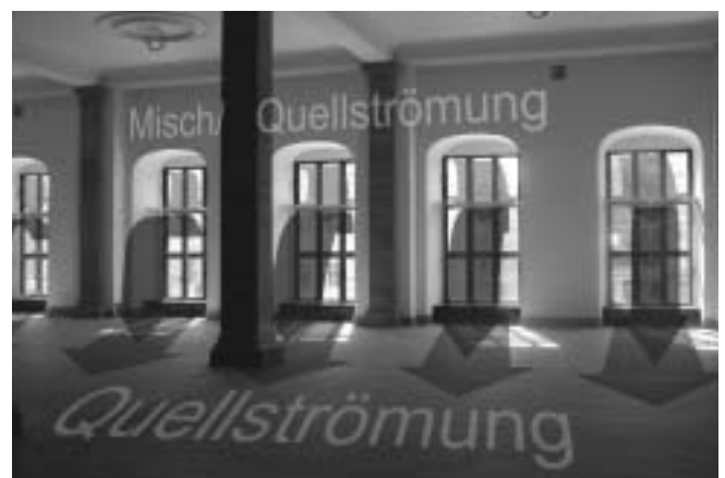
Figuur 8: Stromingsconcept van twee stromingsvormen; verdringingsstroming voor de verse lucht verdeling + meng/verdringing voor het verwarmen/koelen/bevochtigen en ontvochtigen
