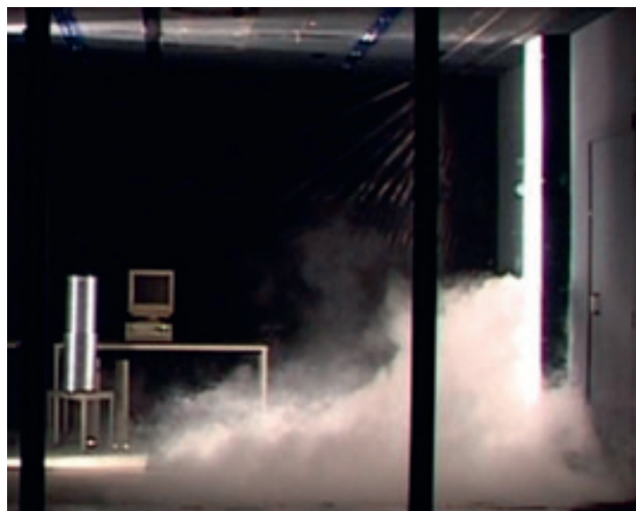
3. De rook laat een mengventilatie zien als de lucht zijwaarts langs de glaswand wordt uitgeblazen.
